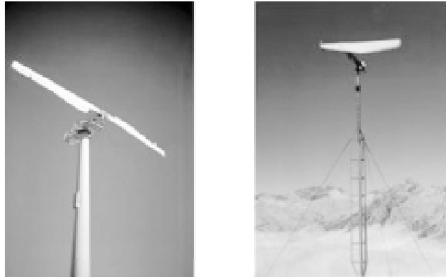
Aerogeneradores “bipala” y “monopala”
