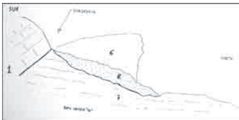
Corte geológico N-S de San Cristóbal (detalle de la zona de Fontanares): 1. Calizas del Dogger. 6. Areniscas. 7. Arcillas. 8. Travertinos. (Dibujo. Rafa Sánchez)
